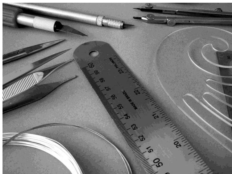
Figura 3.35: Ferramentas para confecção de modelos e maquetes
